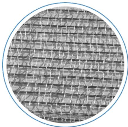
**TCS STEEL X800-A4** è un tessuto unidirezionale in fibra di acciaio inossidabile AISI 316 ad alta resistenza composto da micro funi. Le funi vengono termosaldate mediante un termofilato sia in trama che in ordito per garantire ottima stabilità di posa e lavorabilità in cantiere, mantenendo un perfetto allineamento delle fibre. Il tessuto è applicabile sia con matrice organica per la realizzazione di materiali compositi FRP o matrice inorganica per la realizzazione di materiali compositi FRCM.
