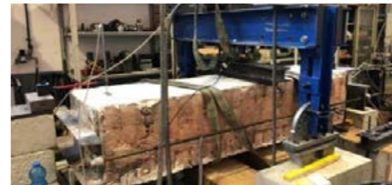
Figura 1. Applicazione della griglia CRM al provino testato in compressione diagonale
