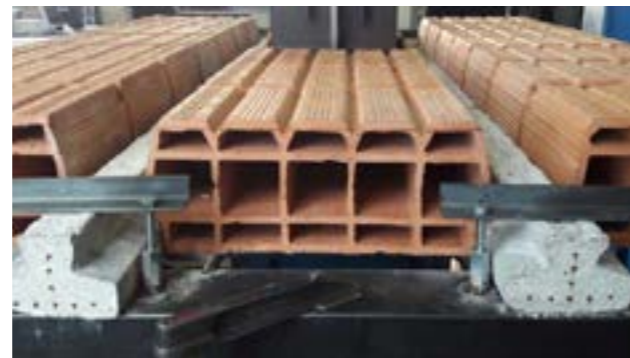
Figura 4. Dettaglio della sezione dei travetti fissati al telaio in acciaio
