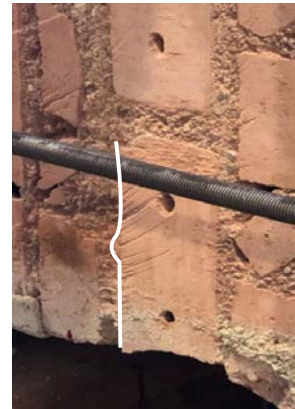
Figura 5. a) Rottura a flessione del provino F\_NR\_1
