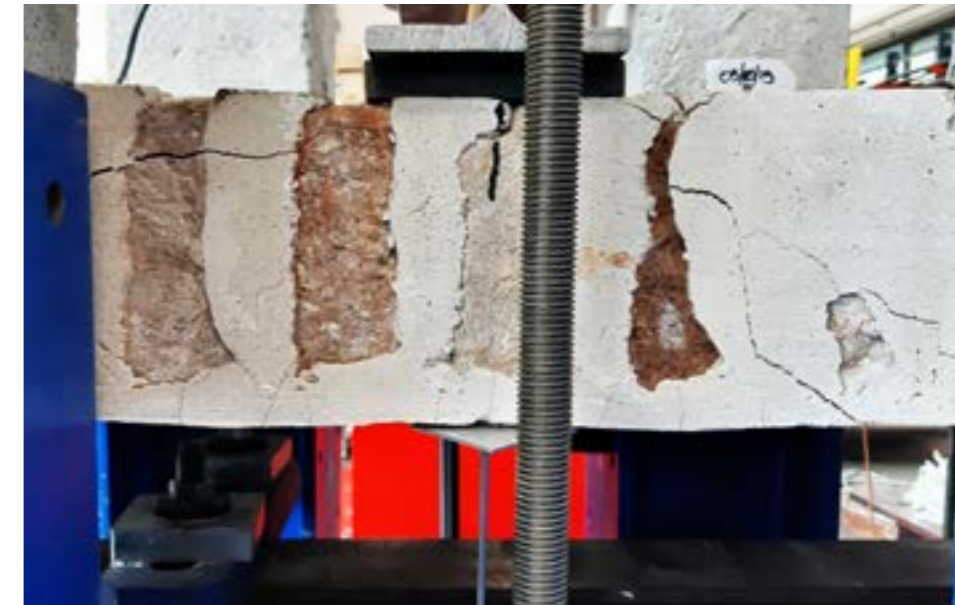
Prove di flessione fuori dal piano
